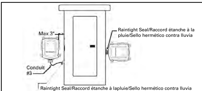
Figure 4. Outdoor Installation (1)/Installation à l'extérieur (1)/Instalación exterior
